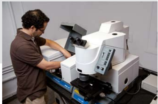
Samir Elouatik, associé de recherche au GCM, sur un FTIR Digilab FTS7000
